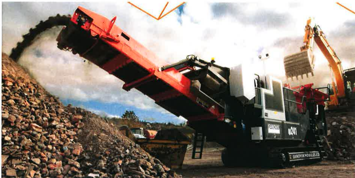
Figure 4 : Concasseur Sandvik QJ241 en fonctionnement avec alimentation par pelle hydraulique
