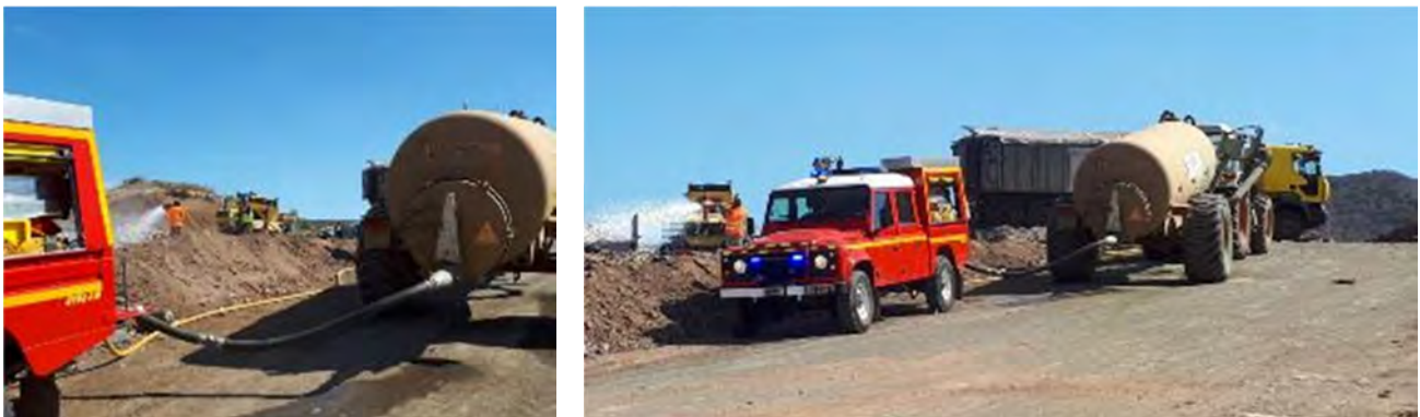
Figure 19 : Véhicule de Première Intervention (VPI) alimenté par la tonne à eau et le tracteur
