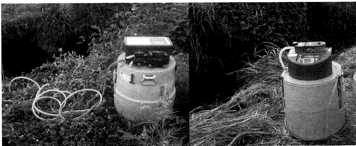
Figure 1 : mise en place de préleveurs. Amont lagune 1 à gauche, aval lagune 4 à gauche.
