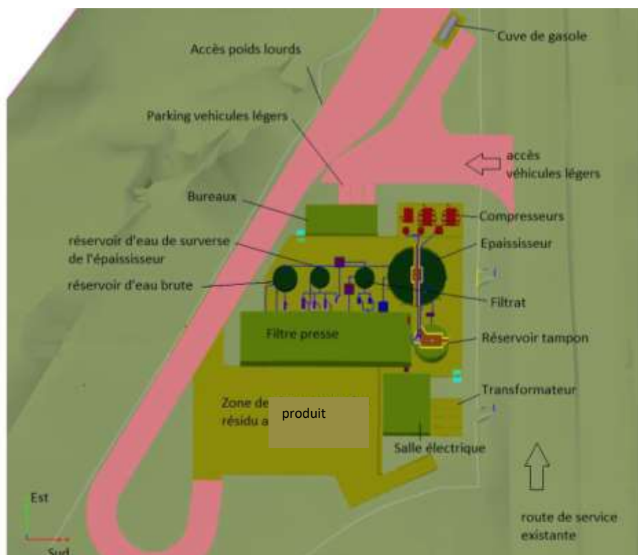
Figure 7 : Implantation des équipements de l'unité DWP1
