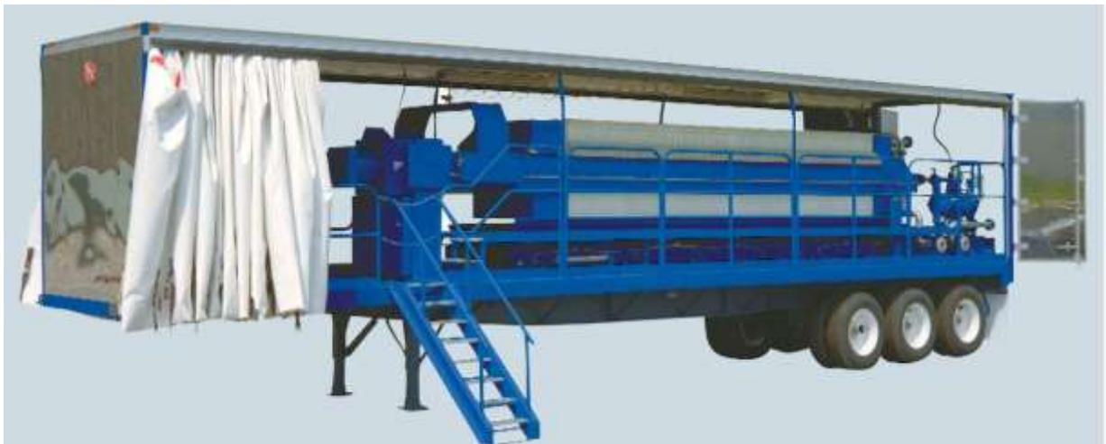
Figure 12 : Photo du filtre presse mobile
