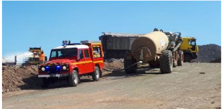
Figure 19 : Véhicule de Première Intervention (VPI) alimenté par la tonne à eau et le tracteur
