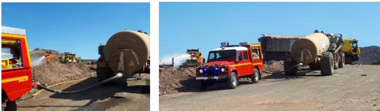
*Figure 19 : Véhicule de Première Intervention (VPI) alimenté par la tonne à eau et le tracteur*
