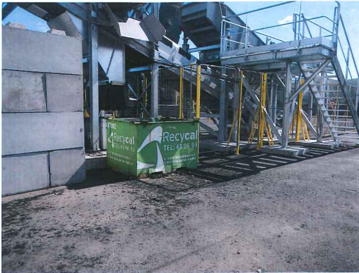
Photo 9 : Benne de récupération des ferailages et fines issues du traitement des pneumatiques au sol
