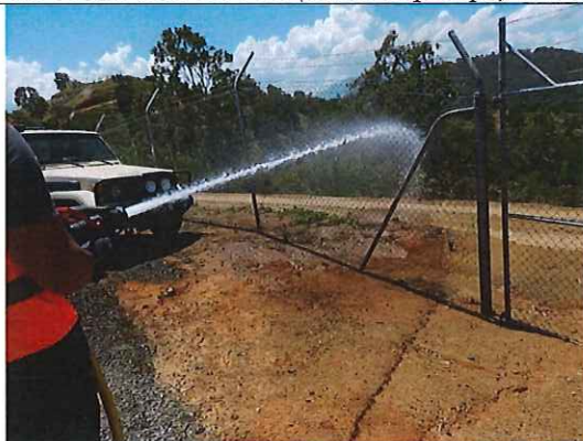
Photo 15 : VPI en fonctionnement (lance petit débit)
