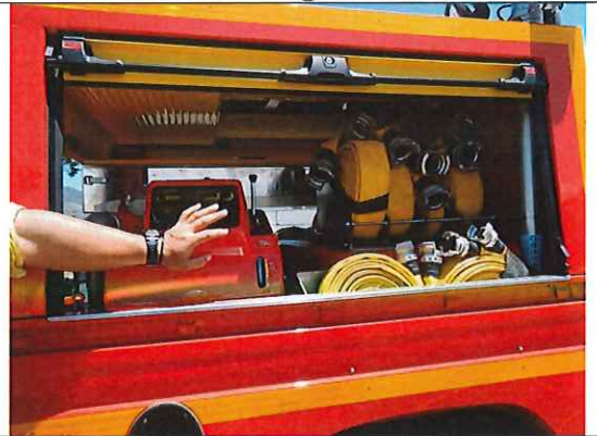
Photo 12 : Intérieur du VPI (lances et pompe) vue de profil
