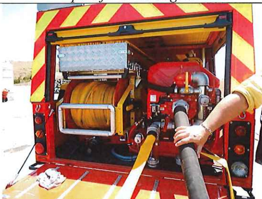
Photo 13 : Intérieur du VPI (lance et pompe) vue arrière
