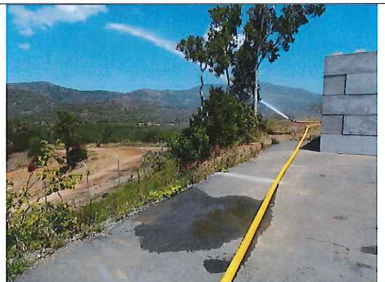
Photo 14 : VPI en fonctionnement (lance gros débit)
