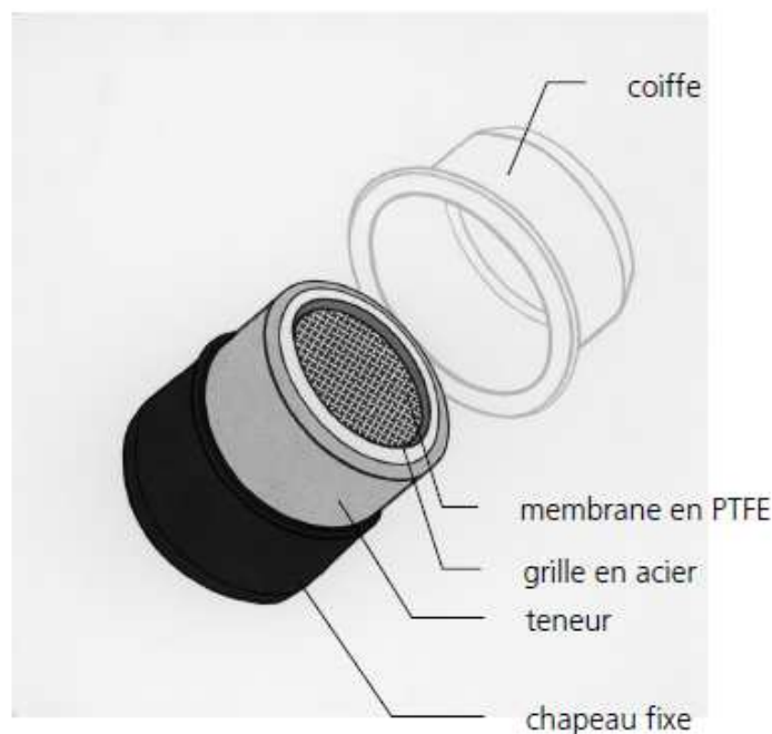
Echantillonneur à membrane en téflon pour la mesure du dioxyde de soufre
