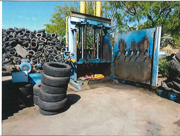
Photo 1 : Presse à pneumatiques à l'arrêt
