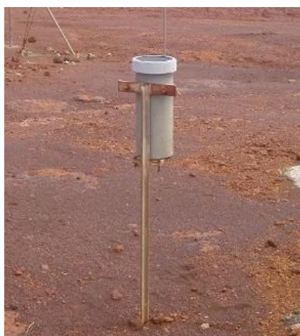
Figure 3 : Dispositif de collecte des eaux de pluie
