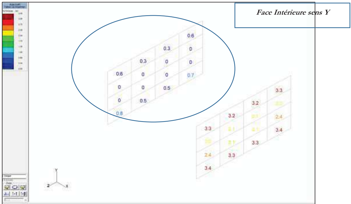
Figure. B-9 : Ferrailage théorique -Face intérieure-Sens Y-Piédroits-D2
