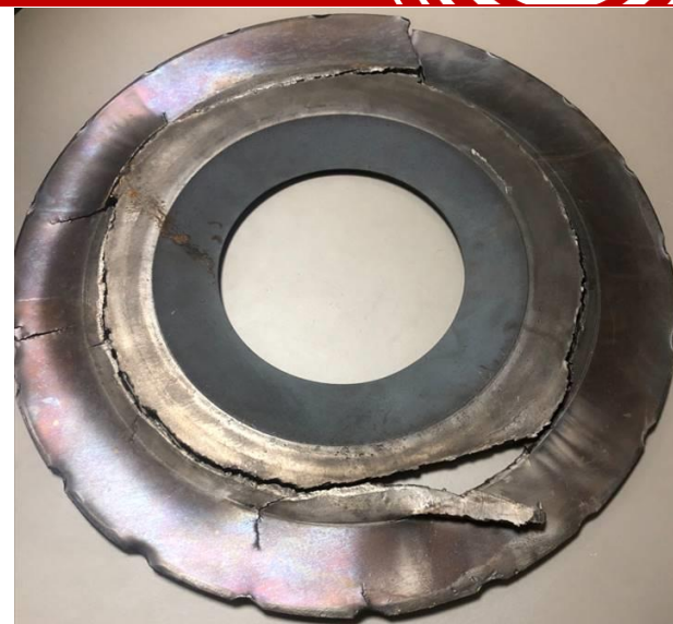
Orifice du FIT-60009 après incident
