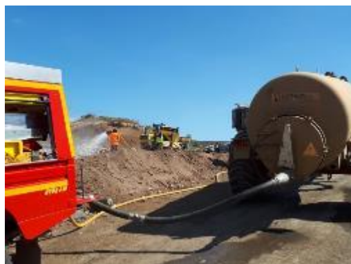
Figure 18 : Véhicule de Première Intervention (VPI) alimenté par la tonne à eau et le tracteur
