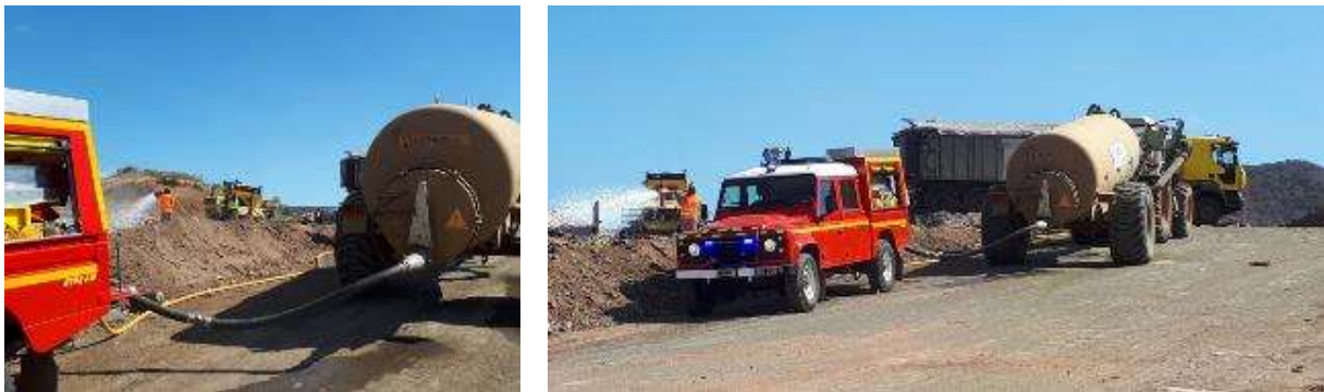
Figure 18 : Véhicule de Première Intervention (VPI) alimenté par la tonne à eau et le tracteur
